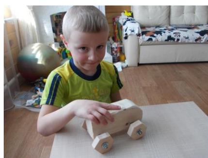
Следующий эксперимент был проведен с колесами шестиугольной формы. И вот мои результаты: на гладкой поверхности стола колеса не крутились, они просто скользили; на шершавой поверхности доски колеса проскальзывали, лишь иногда проворачиваясь на 1-2 сторону шестиугольника; поверхность дивана – колеса крутятся, автомобиль едет с большей легкостью, нежели на треугольных колесах.
